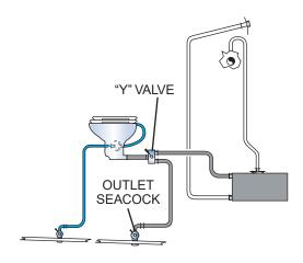
TYPICAL OVERBOARD DISCHARGE SYSTEM KC-0175C-A
