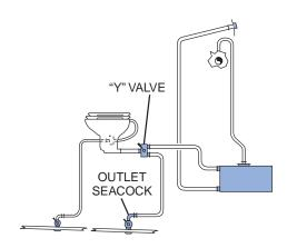
TYPICAL OVERBOARD DISCHARGE SYSTEM KC-0175-A
